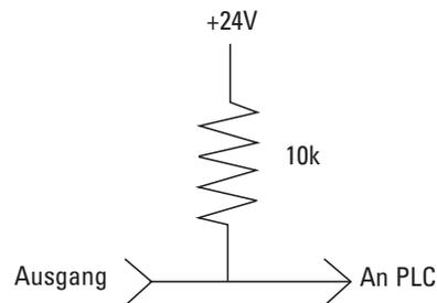
**Abbildung 3-14.** Verbinden von Offen Kollektor-Ausgängen mit einem PLC
