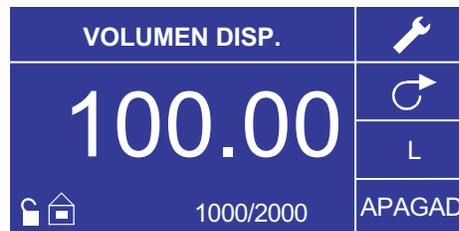
**Figura 3-11.** Operación en modo de descarga de volumen
